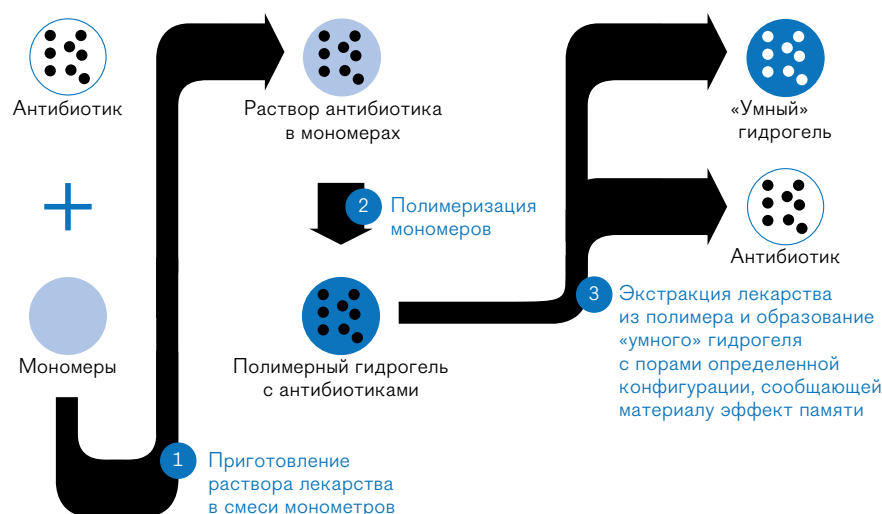
рис. 01 — Процесс получения «умных» полимерных гидрогелей с эффектом памяти
