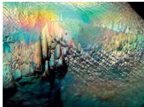
05–07 Растворение алмазов сопровождается появлением на их поверхности изъёмов разной формы
