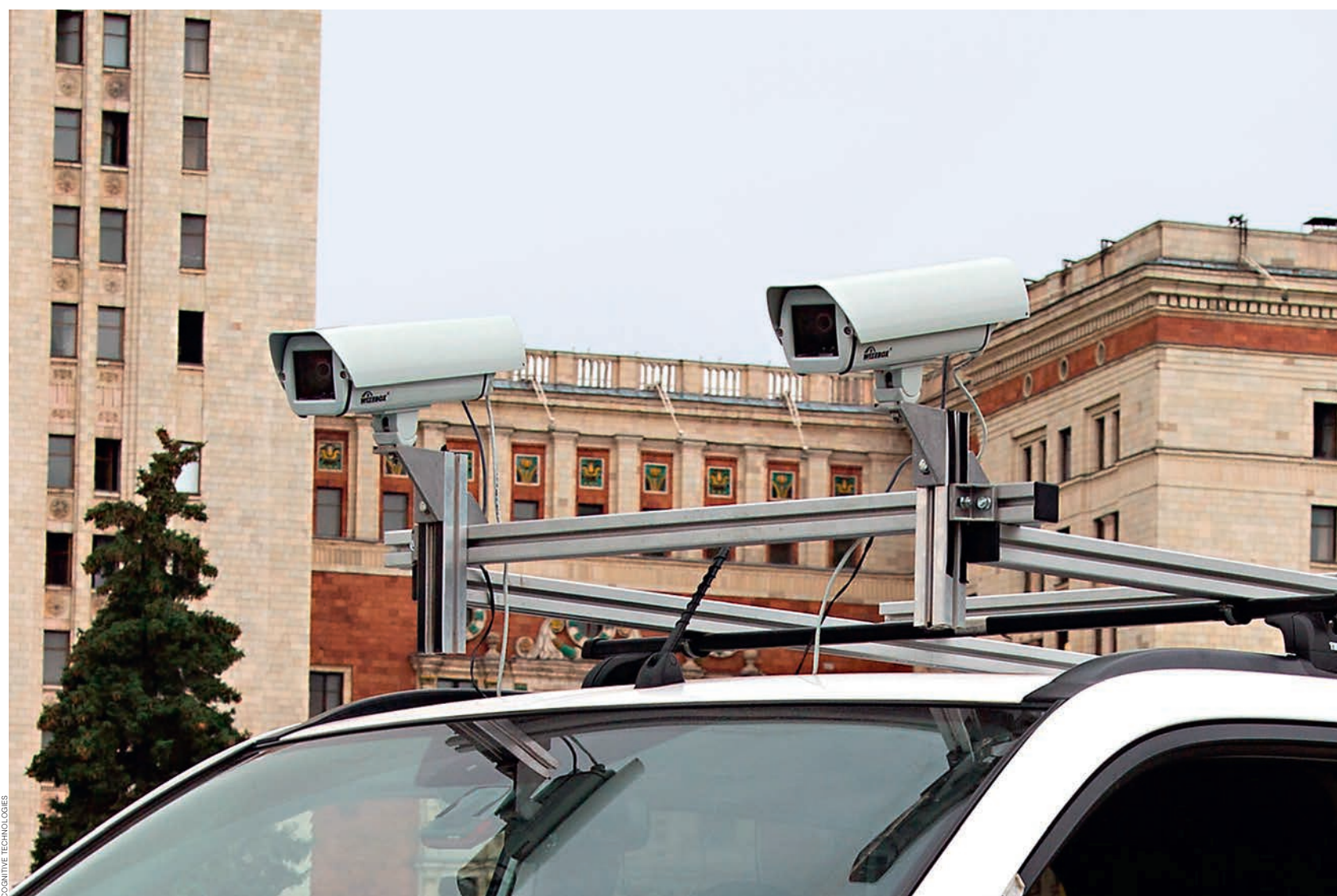
— Камеры прототипа авторобота — основ- ной инструмент полу- чения информации о дорожной сцене
